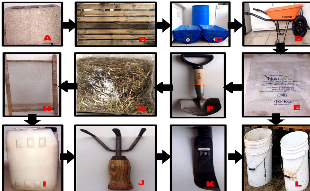
Figura 4. Materiales utilizados para el proceso de elaboración de las lombricompostas a pequeña escala. A) Blocks, B) Tarimas, C) Tanques de 200 Lts, D) Carretilla, E) Costales, F) Palas, G) Zacate, H) Criba, I) Garrafas de 20 Lts. J) Cultivadora manual, K) Machetes, L) Cubetas.
