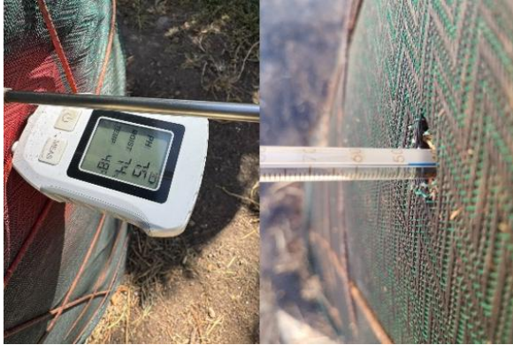
Figura 6. Imagen izquierda medición de humedad y pH, derecho toma de temperatura
