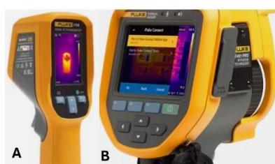
**Equipos termográficos:** “A” termómetro infrarrojo tipo pistola y “B” cámara termográfica
