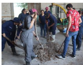
Fig. 3 y 4 Mezcla de melaza con sólidos con pala
