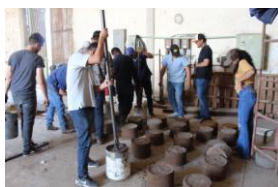
Fig. 5 y 6. Mezclado con la mano y compactación en cubeta
