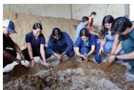
Fig. 5 y 6. Mezclado con la mano y compactación en cubeta
