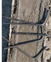
suficiente agua los postes para evitar que se agrieten. Después de 48 horas puedes mover los postes para su almacenamiento, venta o uso.
