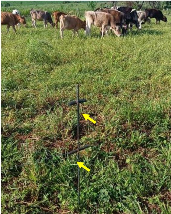
El alambre galvanizado es un excelente conductor para cercas electrificadas. Al instalarlas, se coloca un poste como elemento aislante, por ello se le conoce como aislador. Su función es impedir que los pulsos de voltaje pasen a los muros, o a otra parte de la edificación.
